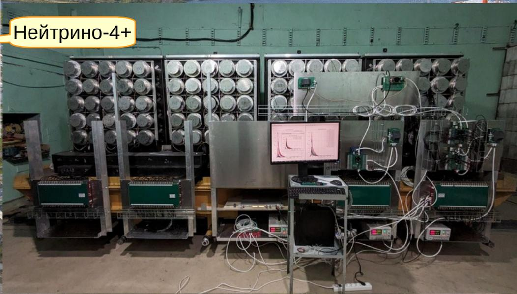
Идёт монтаж оборудования: установлены платформы, детектирующие модули заполнены сцинтиллятором, смонтированы фотоумножители и часть электроники. Монтажные работы продолжаются. Осенью должен начаться набор данных.
