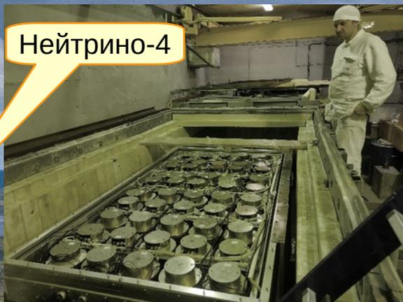
Подвижный детектор L=6-12 м, 1.8 м<sup>3</sup> LS+Gd, 5x10 секций, ФЭУ сверху, нет PSD, 3.5 м в.э., S/B~0.5
