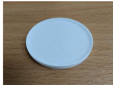
Гетерогенный сцинтиллятор. Содержание сцинтиллятора 35%. Компаунд Силикон
