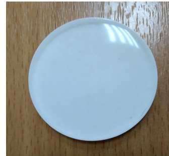
Гетерогенный сцинтиллятор. Содержание сцинтиллятора 35%. Компаунд эпоксидная смола
