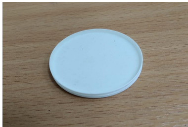
Гетерогенный сцинтиллятор. Содержание сцинтиллятора 35%. Компаунд эпоксидная смола
