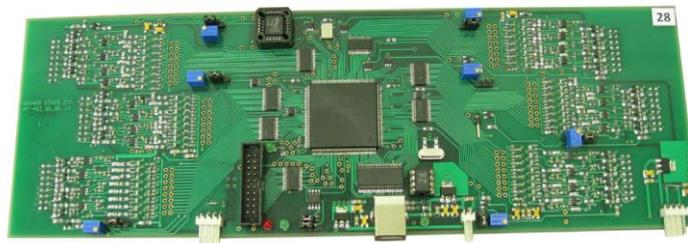
Плата считывания на базе FPGA ALTERA
