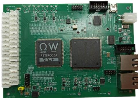
Плата считывания на базе ASIC PETIROC 2B и FPGA Cyclone III
