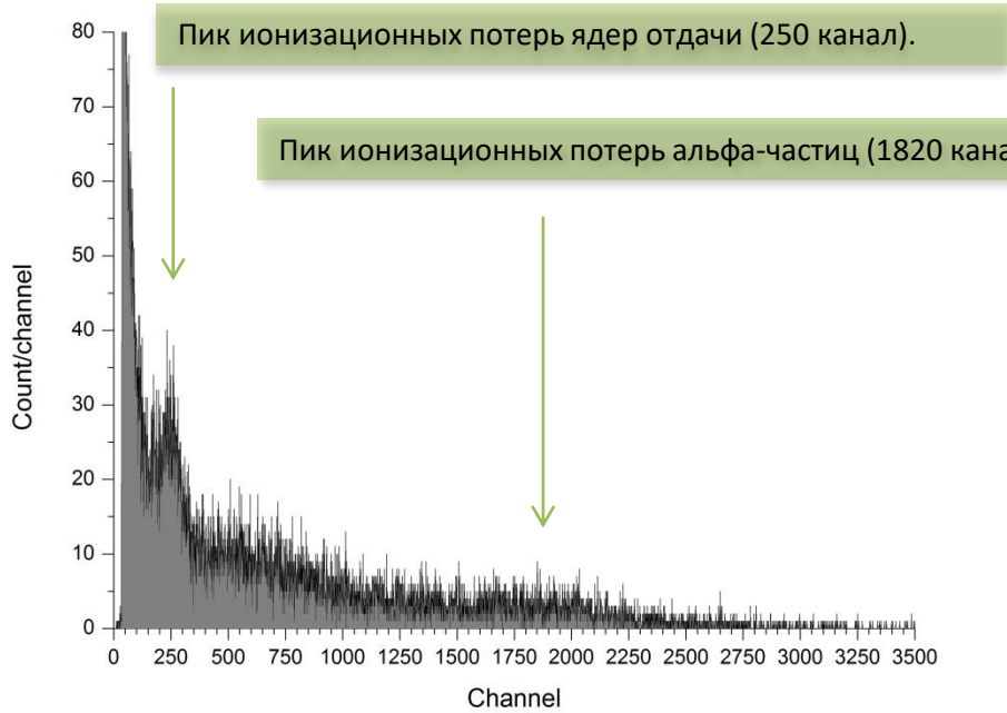
Рис.2. Амплитудный спектр импульсов от поверхностного \alpha -сточника ^{222}\text{Rn}
