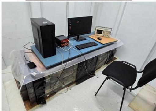
Выполнена отладка и технический пуск экспериментальной установки с прототипом детектора в отдельном низкофоновом боксе лаборатории НЛГЗ-4900 БНО ИЯИ РАН. Проведена калибровка прототипа детектора несколькими калибровочными радиоактивными источниками ( $^{241}\text{Am}$ ,  $^{137}\text{Cs}$ ,  $^{232}\text{Th}$ ). Проведено более 2000 часов измерений фона прототипа детектора.
