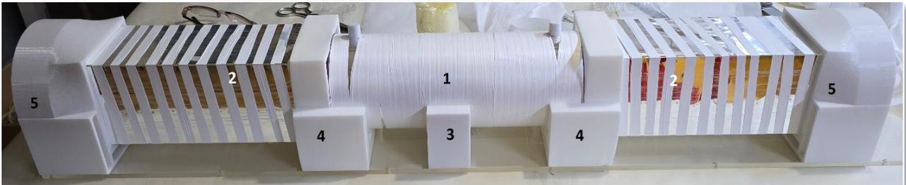
1 – кварцевая ячейка, обернутая отражателем VM2000 + фторопластовая лента, 2 – световоды, обернутые отражателем VM2000 + фторопластовая лента, 3 – подставка под кварцевую ячейку, материал PETG, 4 – переходники для оптического соединения кварцевой ячейки и световодов, материал PETG, 5 – переходники для оптического соединения световодов и ФЭУ, материал PETG.
