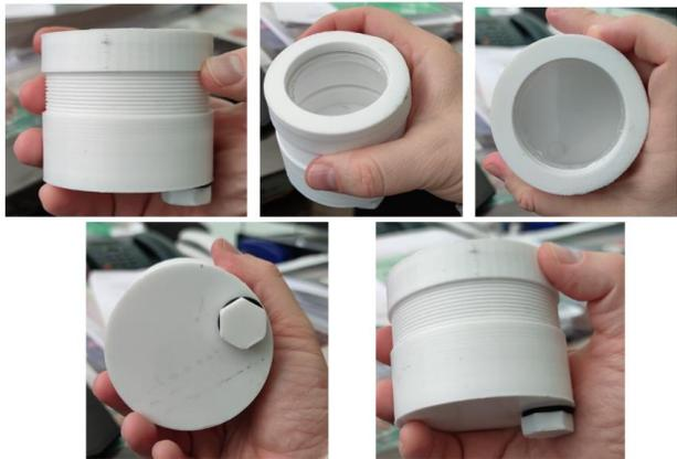
Сцинтилляционная ячейка, напечатанная на 3D-принтере. Объем ~ 73 см<sup>3</sup>
