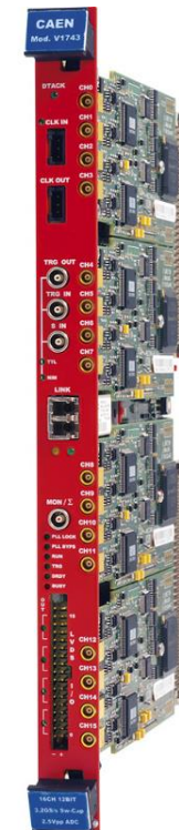
Рисунок 9 – Характеристики дигитайзера CAEN v.1743 [5]
