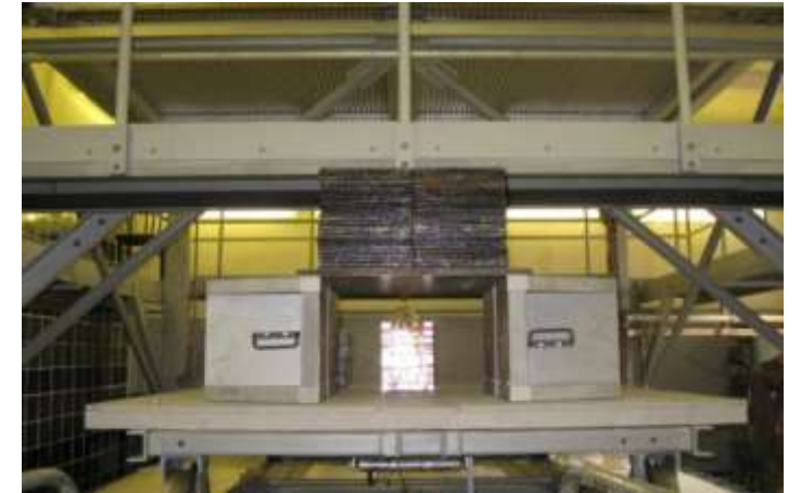
Свинцовый куб с ребром 20 см под 30 см стали
