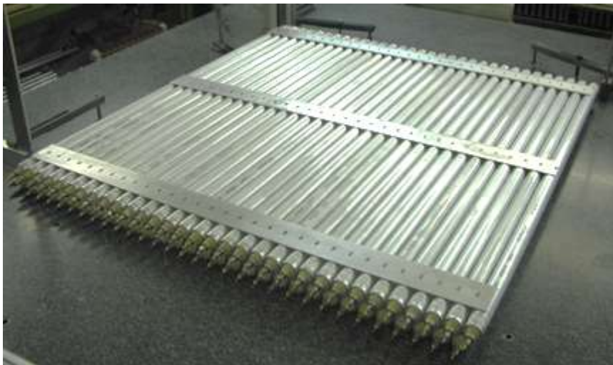
Трековая камера с трубками длиной 1 м
