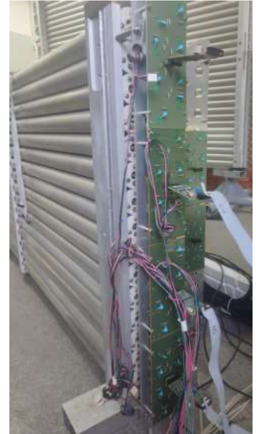
Торец камеры с переходными платами и усилителями
