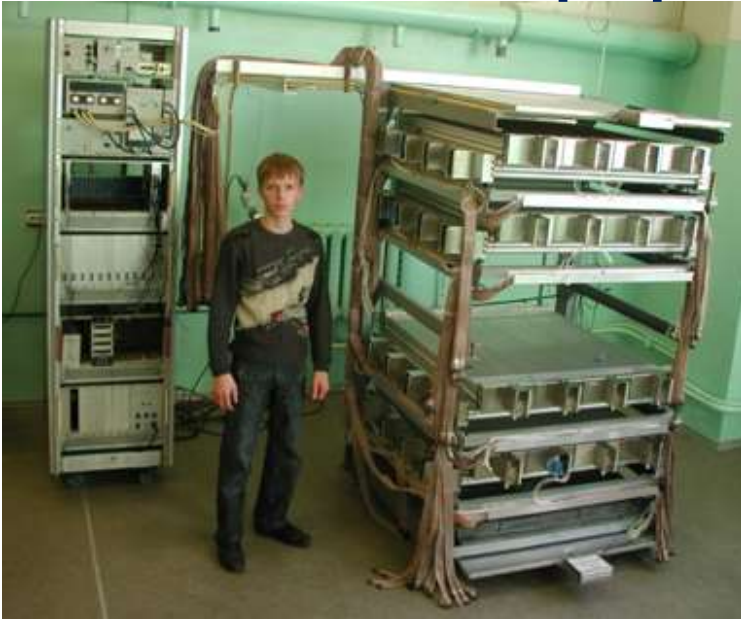
Лабораторный макет мюонного томографа площадью 1 м 2
