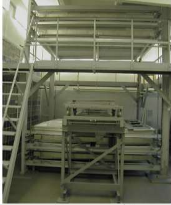
Мюонный томограф площадью 3 x 3 м 2
