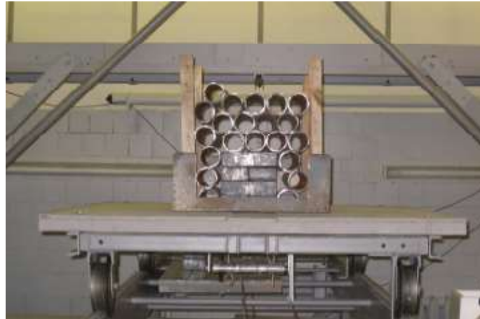
Свинцовый куб с ребром 20 см под слоем стальных труб
