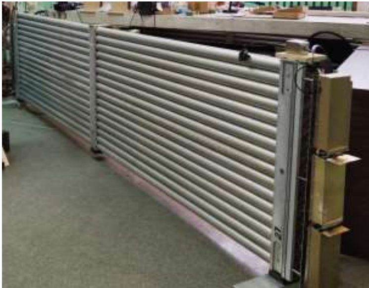
Трековая камера с трубками длиной 3.7 м
