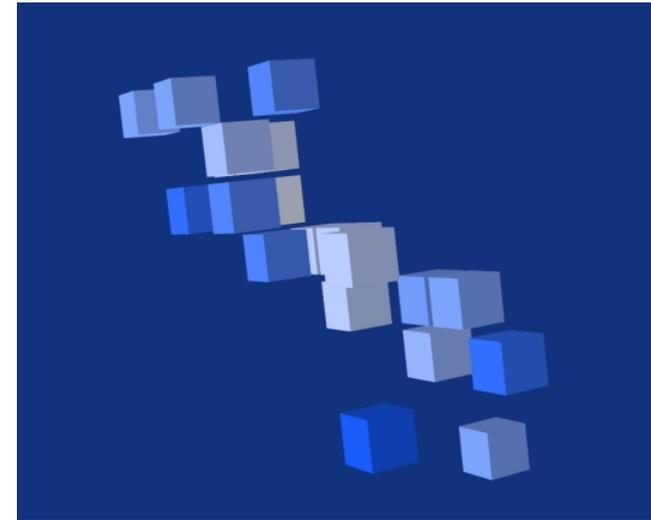
Программа обработки информации для построения 3D событий по измерениям работает пока в тестовом режиме с данными от двух матриц (128 каналов). Третья проекция события строится по двум полученным в измерениях. Две матрицы по 64 КФЭУ делят просматриваемый рабочий объем на 512 кубиков. Каждый КФЭУ первой матрицы регистрирует фотоны от 8 кубиков (КФЭУ) соответствующего ряда второй матрицы (и так программа определяет координаты и значения яркости кубиков для всех 64 КФЭУ).
