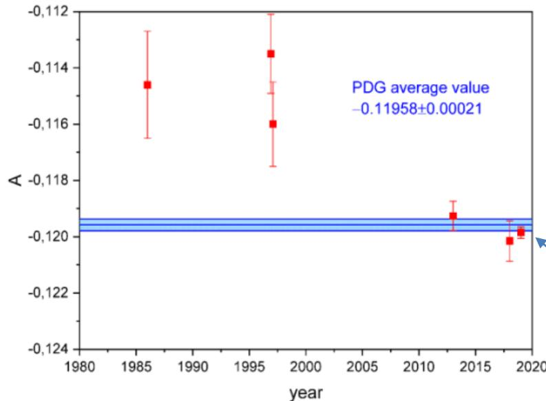
Измерения электронной асимметрии распада нейтрона ( $A$ ) и усредненный результат PDG [18].
