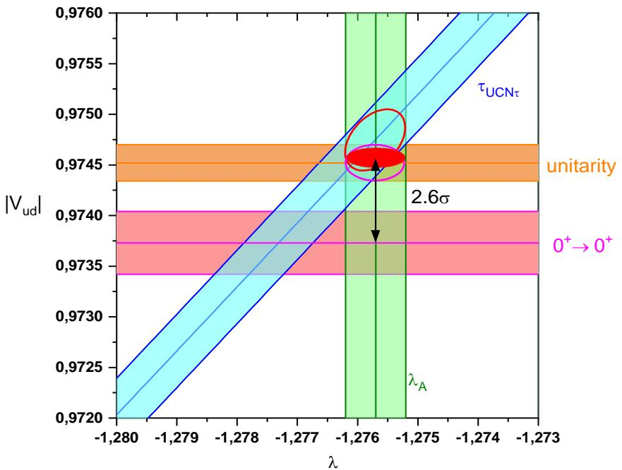
Зависимость элемента матрицы смешивания夸克ов  $V_{ud}$  от  $\lambda$ , рассчитанная с использованием формул СМ из распада нейтрона, из экспериментов с фермии-сверхразрешенными ядерными переходами  $0^+ - 0^+$  и из унитарности матрицы СКМ с использованием  $V_{us}$  измерений [18].
