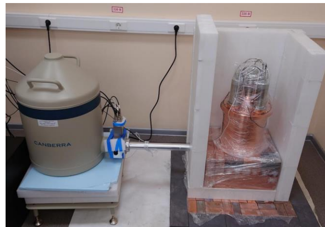
Тестовые измерения с HPGe детектором массой 1 кг
