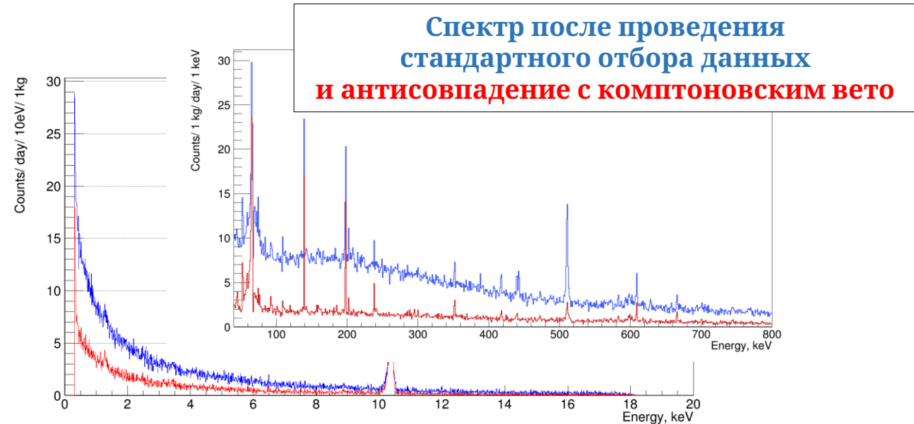
Тестовые измерения с HPGe детектором массой 1 кг
