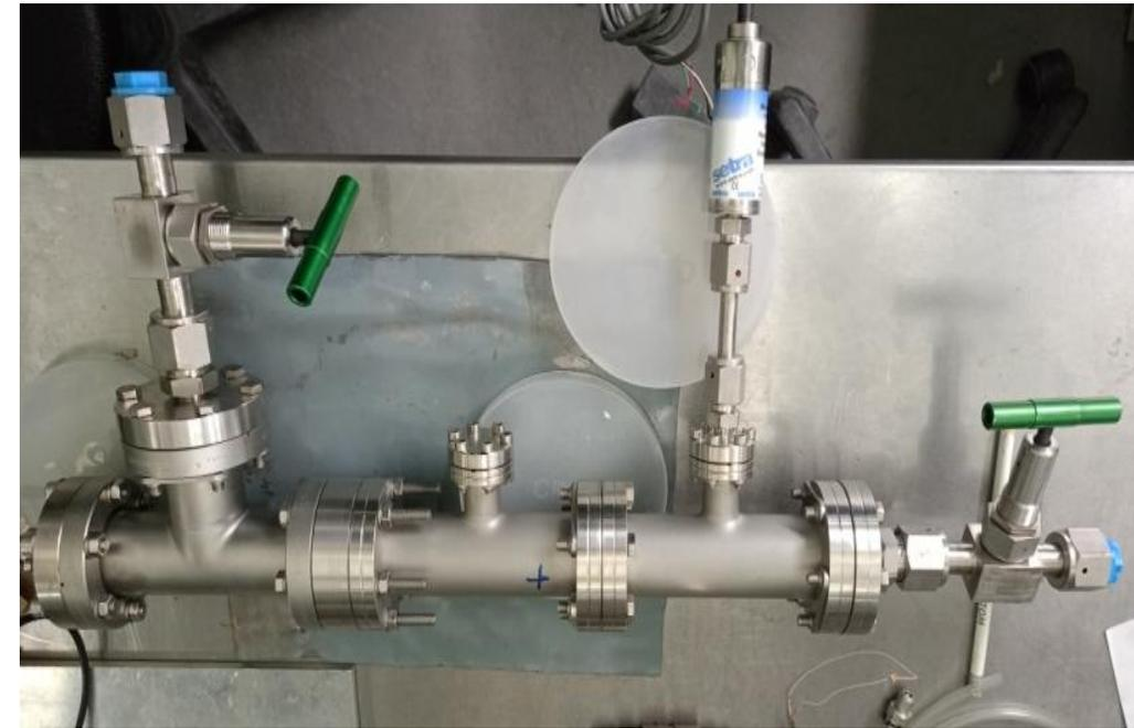
Рис.8. Фото пропорционального счётчика.
