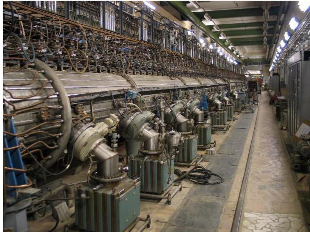
**5 Drift Tube Tanks**
